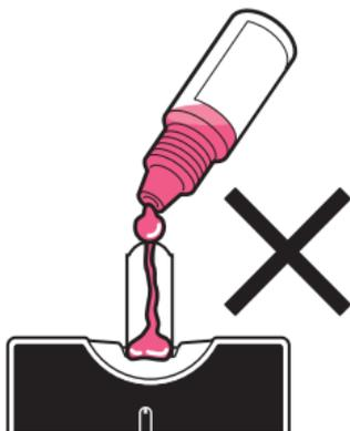
**重要** G センサーの先端を上向きにした状態でコントロール液を接触させないでください。センサー挿入口から内部にコントロール液が入り、故障の原因になります。
