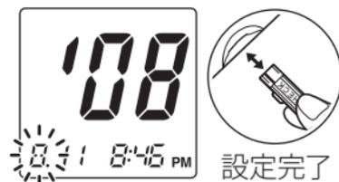
③変更したい項目の点滅中に、点検チップを抜き差しします。
