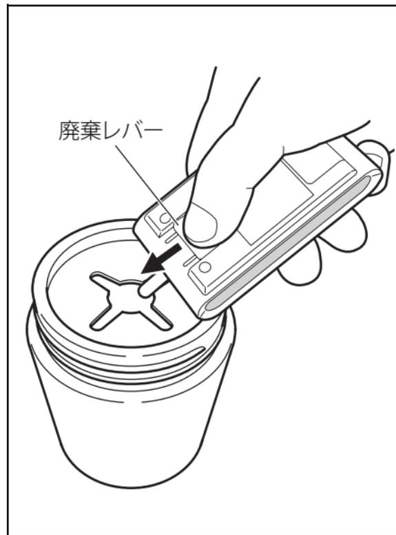
③廃棄レバーをスライドさせてダイアセンサをはずします。電源が自動的に切れます。
